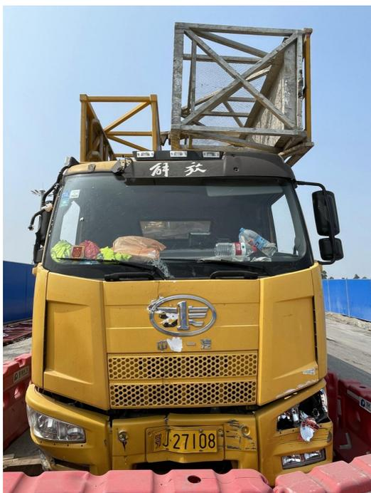
**车辆司法鉴定结论:** 鄂 J27108 桥梁检测作业车制动性能合格，转向性能不合格。（广东安盈痕迹司法鉴定所）
