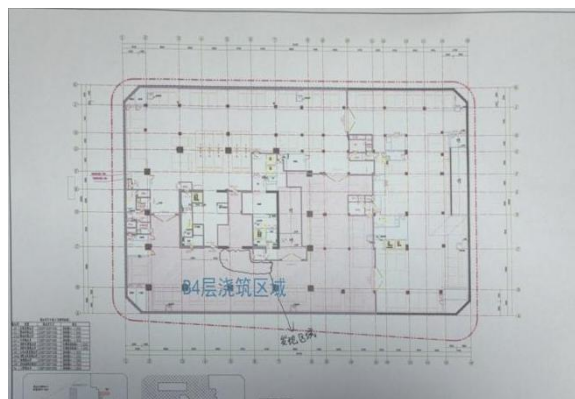
图 2 负 4 层混凝土浇筑区域
